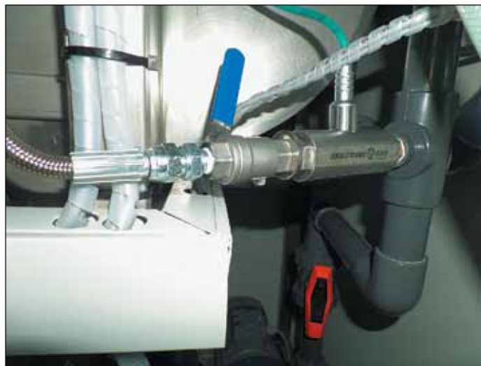
Рис. 2. Система датчиков Zestron Eye, встроенная в установку отмычки
