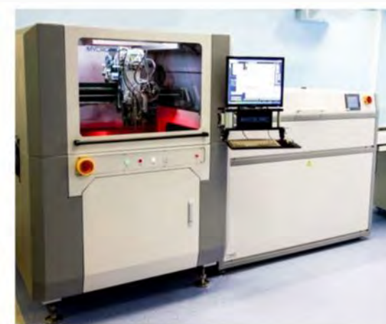
Система селективного нанесения влагозащитных материалов Mycronic MYC50. Печь УФ-отверждения UV 1600
