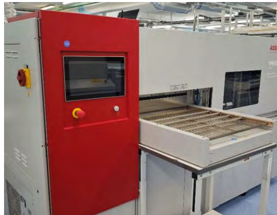
Парофазная печь Asscon VP6100 с вакуумной зоной
