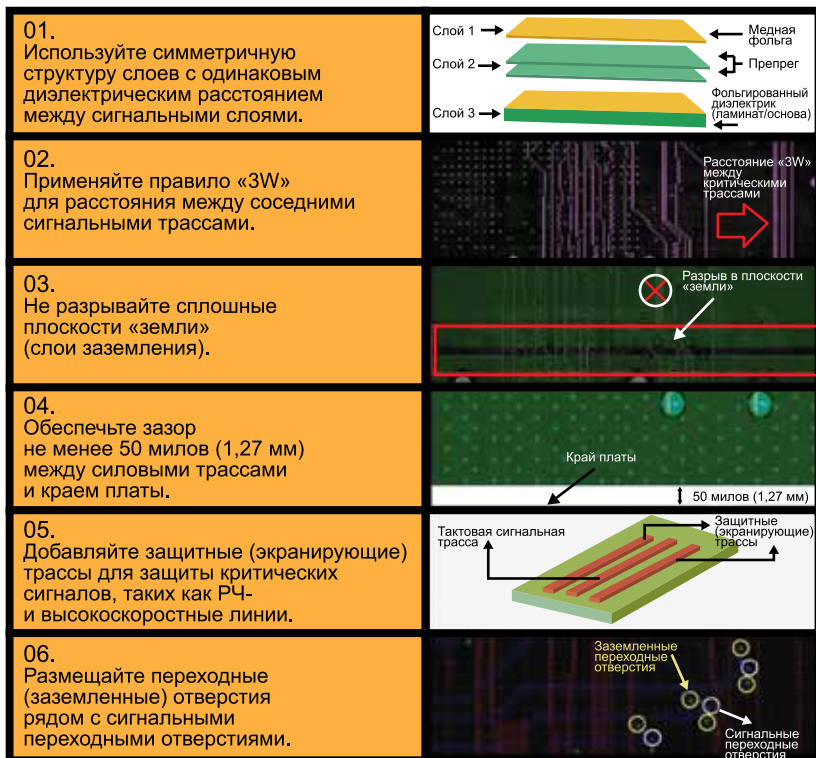
Рис. 1. Шесть принципов снижения перекрестных помех в проектах печатных плат
