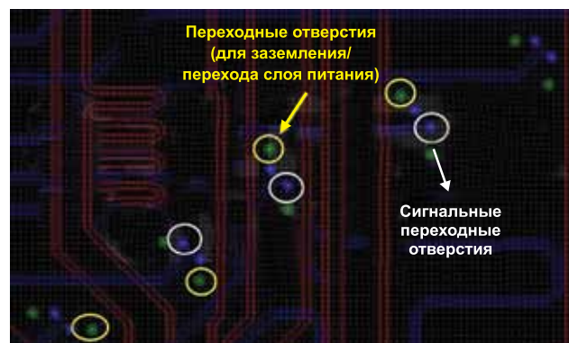
Рис. 18. Переходные отверстия рядом с сигнальными переходными отверстиями
