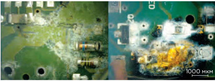
1 Повреждения, вызванные электрохимической миграцией (слева) и пробоем диэлектрика (справа)
