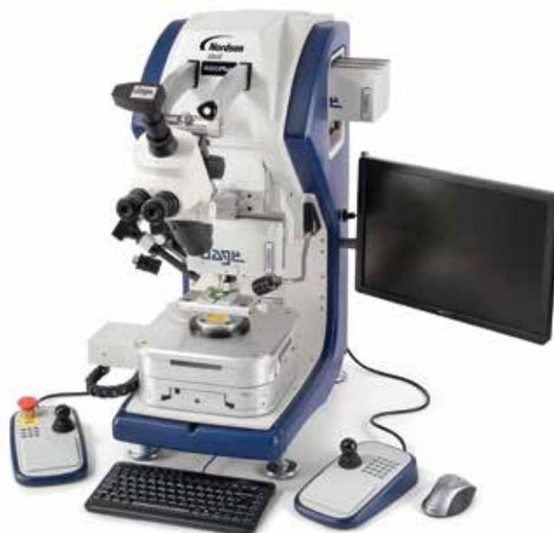
10 Установка тестирования микросоединений 4000Plus
