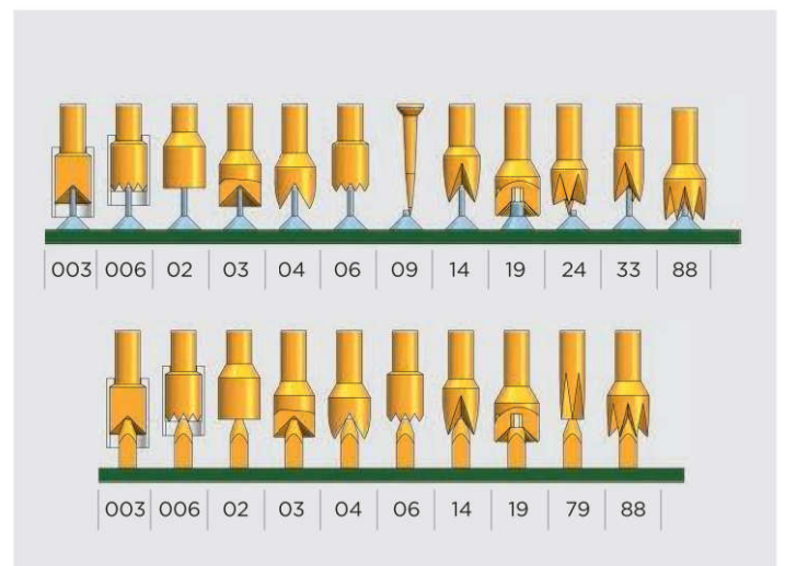
6 Типы наконечников для контакта в штыревые выводы
