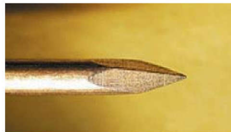
9 Наконечник иглы после 10 циклов очистки
