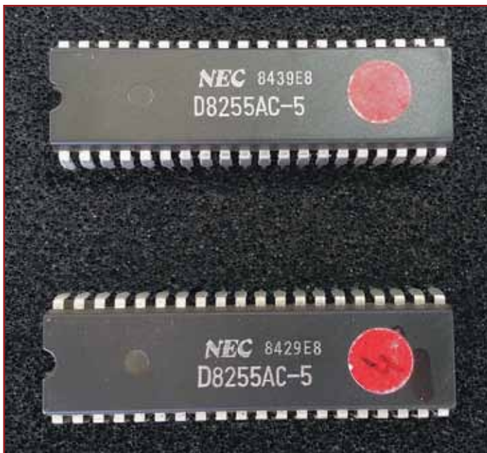
Рис. 1. На первый взгляд маркировка на корпусе микросхемы очень похожа на оригинальную. Можете определить, какая из этих микросхем оригинальная?
