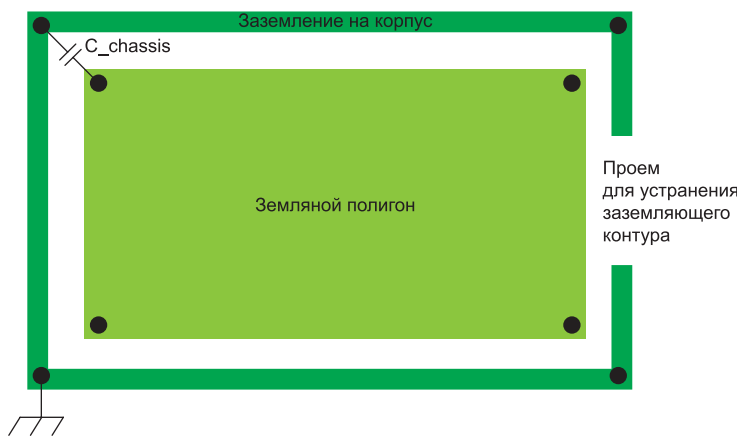
Рис. 8. Устранение заземляющего контура в плоскости заземления шасси
