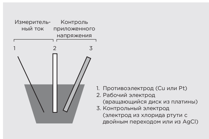
Осаждение меди из кислого электролита: метод получения поляризационной кривой – трехэлектродная ячейка
