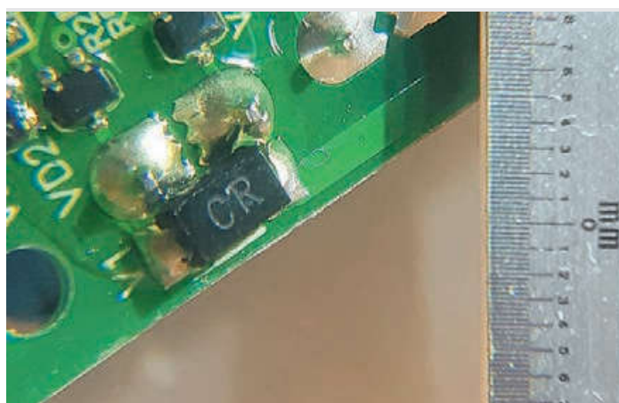
11 Дефект пайки (образование перемычек из припоя)
