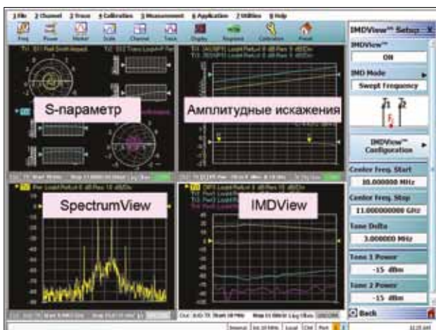
▲ Рис. 3. Система Vector Star в сочетании с прикладным программным обеспечением Imovie обеспечивает отображение S-параметров, амплитудного искажения, спектра и интермодуляционных составляющих при настройке на двухтональные измерения IMD
