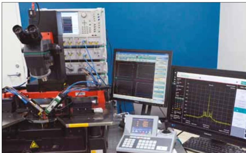
▲ Рис. 1. Настройка широкополосной системы VectorStar ME7838x, коаксиального прецизионного направленного ответвителя MN25110A W1 (110 ГГц) и ультрапортативного анализатора спектра Spectrum Master MS2760A для измерений на пластине
