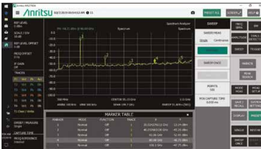
▲ Рис. 8. Дисплей анализатора спектра Spectrum Master MS2760A предоставляет возможность мониторить низкочастотные резонансы, отслеживая до 5-й гармоники двухтонального измерения IMD с частотой 20 ГГц
