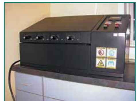
Рис. 6. Аппарат парового старения, используемый для воздействия на припой на покрытиях ENIG и EPIG
