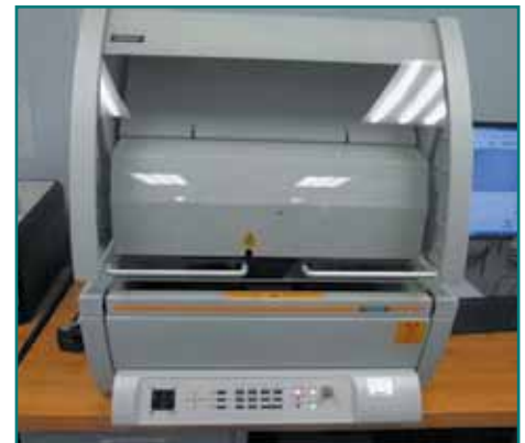
Рис. 5. Аппарат рентгенолюминесценции для измерения толщины покрытий ENIG и EPIG на тестовых образцах
