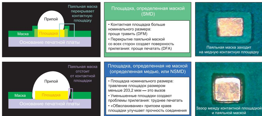
Рис. 8. Влияние способа определения контактной площадки на DFX
