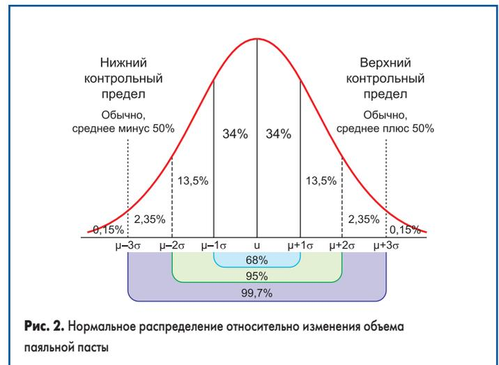
Рис. 2. Нормальное распределение относительно изменения объема паяльной пасты
