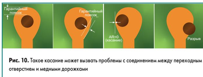
Рис. 10. Такое касание может вызвать проблемы с соединением между переходным отверстием и медными дорожками
