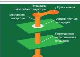
Сквозные отверстия без соответствующих зазоров соединяют все опорные плоскости и вызывают короткое замыкание.                                 | Сделайте вырез в опорном слое на 16 мил больше, чем размер просверленного отверстия.                                                                                                                                     |
