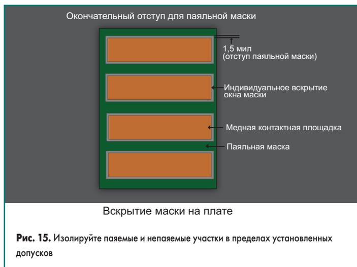
Рис. 15. Изолируйте паяемые и непаяемые участки в пределах установленных допусков
