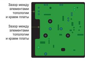
Недостаточный зазор между медными элементами и краями платы приводит к короткому замыканию между соседними слоями.                            | Зазор между медными элементами и краями платы должен составлять не менее 10 мил                                                                                                                                          |
