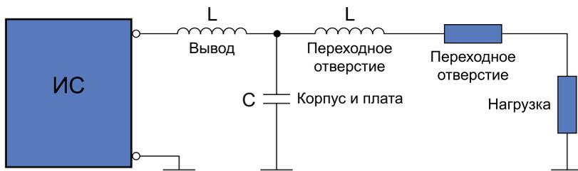
Рис. 6. Схема фильтра нижних частот Т-типа с индуктивностью переходного отверстия, паразитной емкостью между платой и контактной площадкой, а также индуктивностью вывода в качестве основных частей
