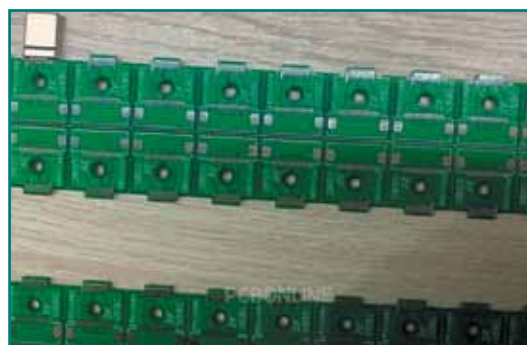
Рис. 1. Бессвинцовые покрытия HASL
