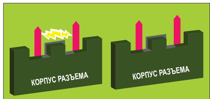
Рис. 2. Влажность приводит к пробую напряжения и искрению
