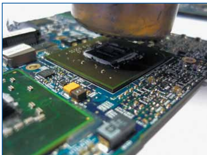
Рис. 6. Сопутствующее повреждение, вызванное теплом
