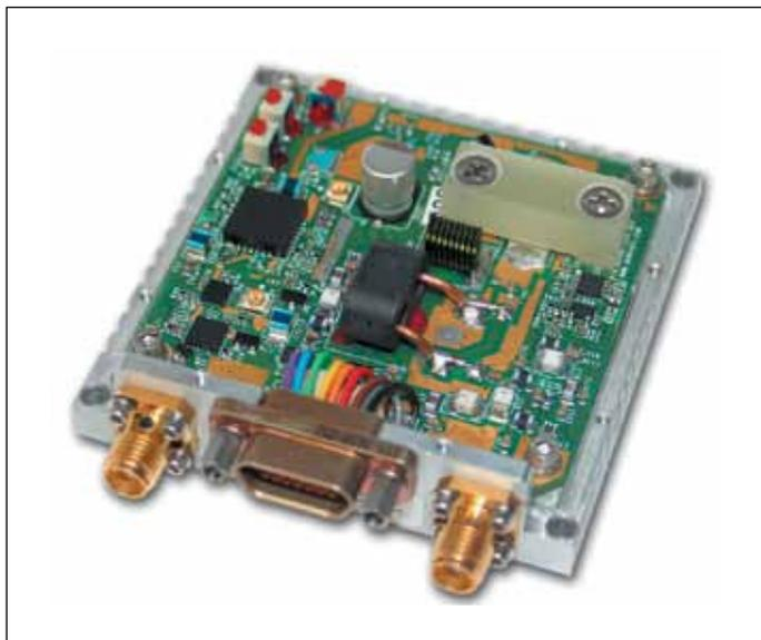
**Рисунок.** NuWaves UHF — двунаправленный модуль усилителя мощности, включающий как ММІС, так и дискретные схемы усиления мощности
