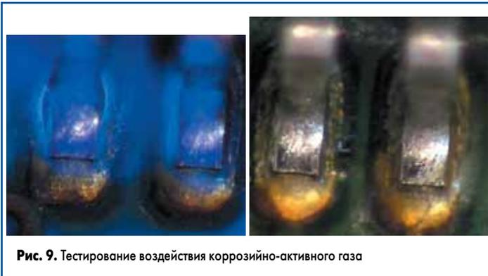
Рис. 9. Тестирование воздействия коррозионно-активного газа
