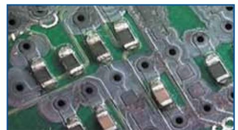
**Рис. 8.** Плата, прошедшая термоциклирование
