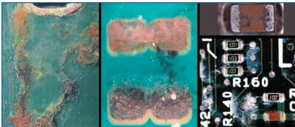
**Рис. 2.** Коррозия компонента (источник фото: Foresite, Inc.)
