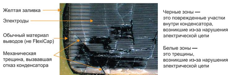
Рис. 2. Пример конденсатора, произведенного клиентами Knowles Precision Devices
