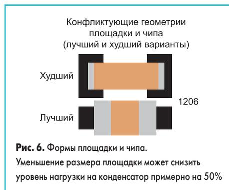
**Рис. 6.** Формы площадки и чипа. Уменьшение размера площадки может снизить уровень нагрузки на конденсатор примерно на 50%
