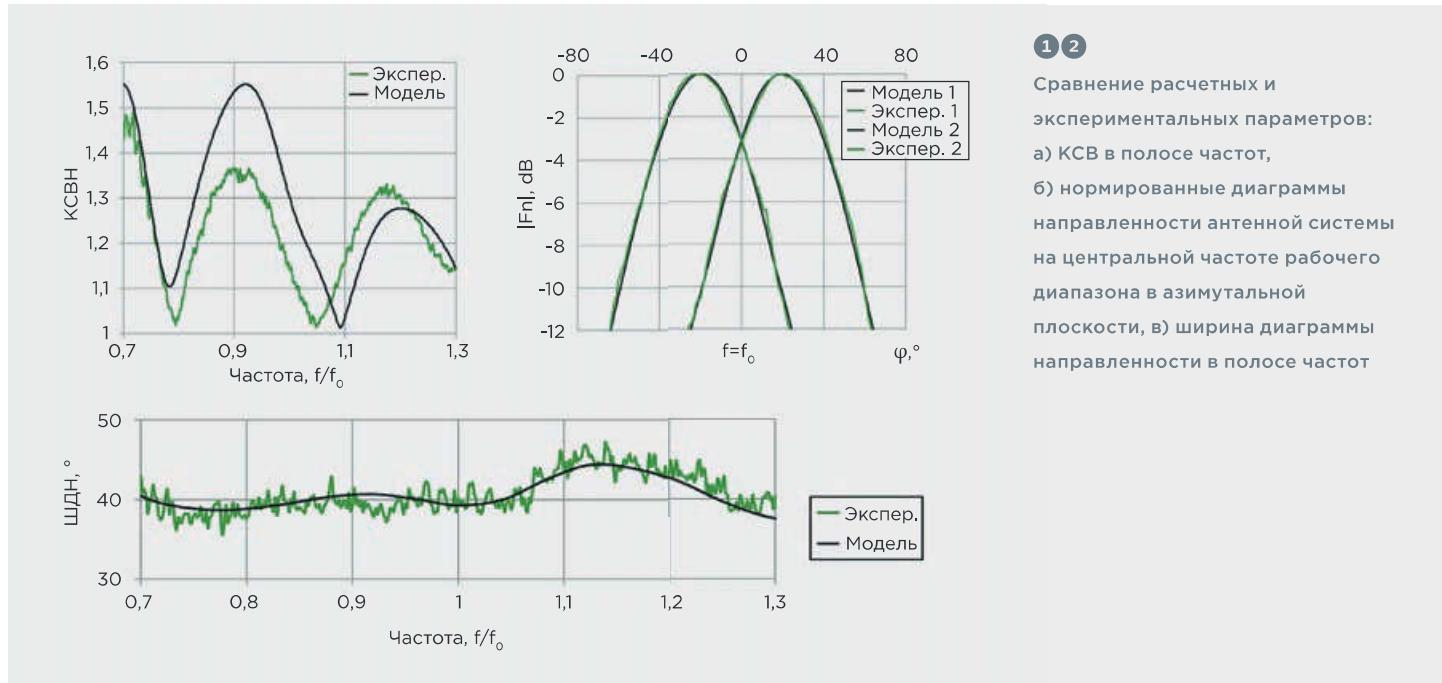
моделирования, где проводящий материал представляет собой идеальный проводник. Диаграммы направленности макета и модели антенной системы на центральной частоте диапазона показаны на РИС 1-2б. А на РИС 1-2в представлены результаты измерения ширины диаграммы направленности (ШДН) в полосе частот. Результаты измерений показывают хорошую корреляцию с теоретическими расчетами и подтверждают соответствие требований к электрическим характеристикам.
