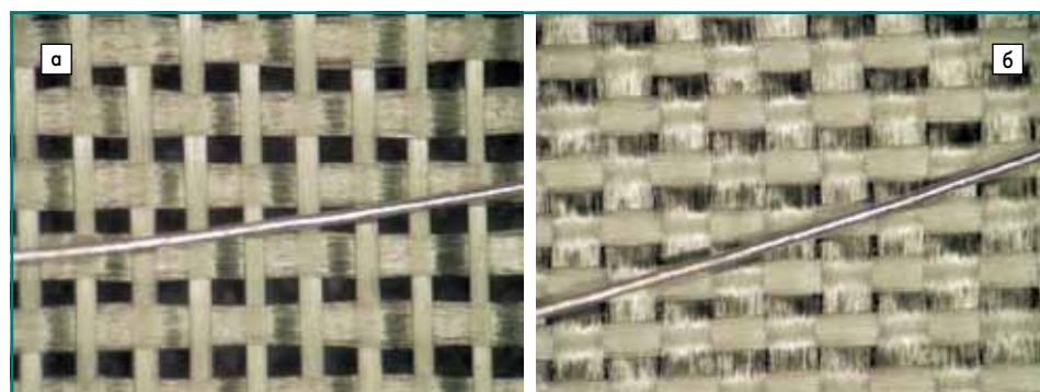
Рис. 4. Можно смягчить диэлектрические эффекты, которые вызывает переплетение волокон печатной платы.
