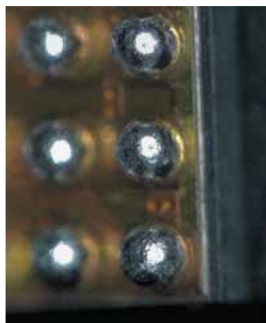
Рис. 12. Изображение с микроскопа WLP после успешного реболлинга
