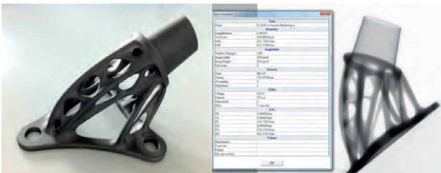
Компьютерная томография изделия для анализа пор, пустот, а также расчета толщины стенок
