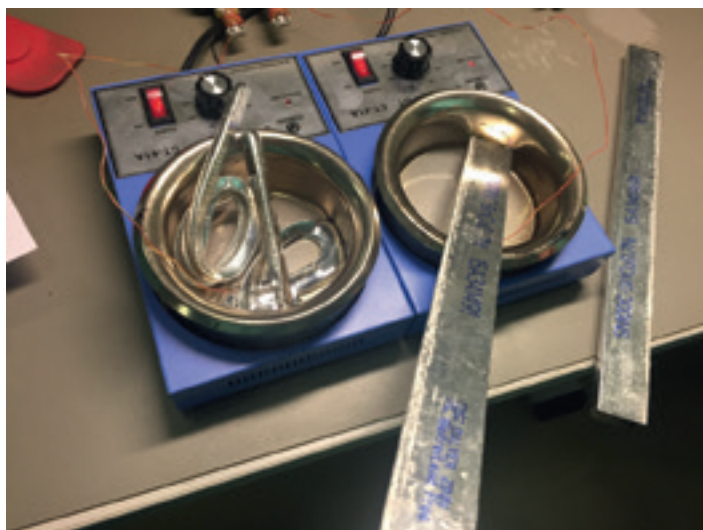
Сравнительные испытания бессвинцового припоя Elsold SN100 MA-S у заказчика
