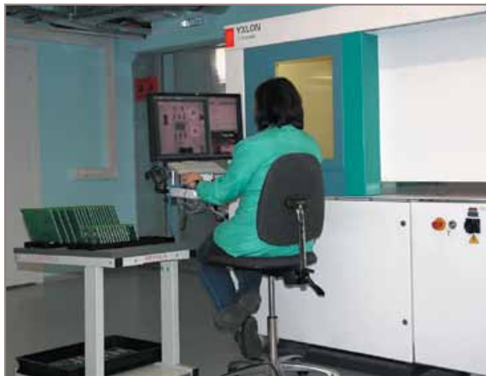
Рис. 3. Установка рентген-контроля в работе
