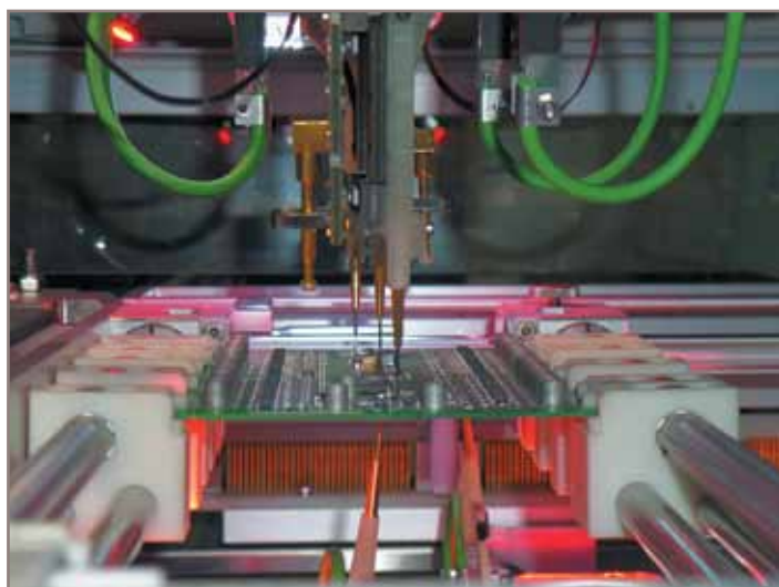
Рис. 5. Внутрисхемный контроль. Благодаря расположению четырех пробников сверху и двух снизу тестируемый узел не требует переворачивания для отладки и тестирования, что сокращает затраты времени на проверку всего узла
