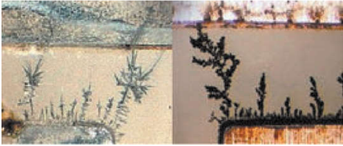
7 Токпроводящие дорожки - дендриты - на поверхности печатных плат
